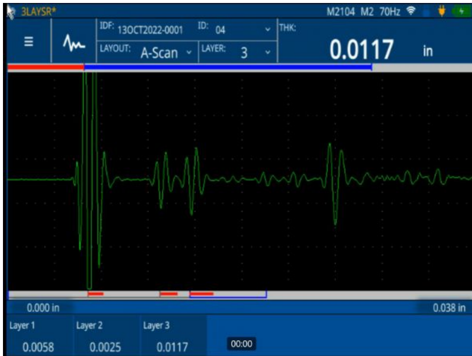
72DL PLUS超音波厚さ計を使用して実施した3層プラスチック製容器の50 MHz測定
